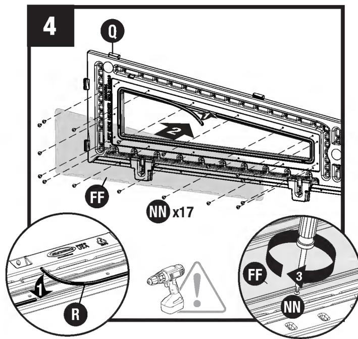
Placer le chevêtre gauche (Q) sur une surface plane, face vers le bas. Insérer un joint (R) dans la rainure autour de l'ouverture de fenêtre. Placer la vitre latérale (FF) sur l'ouverture de la fenêtre. Fixer la vitre avec 20 vis (NN). Répéter l'opération pour le chevêtre droit (O).
