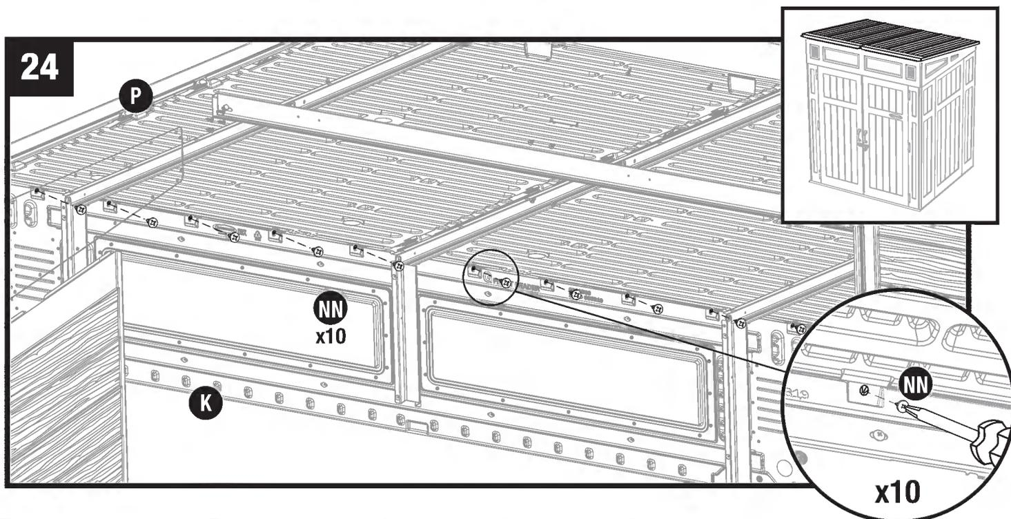
Fixer les panneaux de toit (P) sur le haut du chevêtre avant (L) à l'aide de dix vis (NN).
