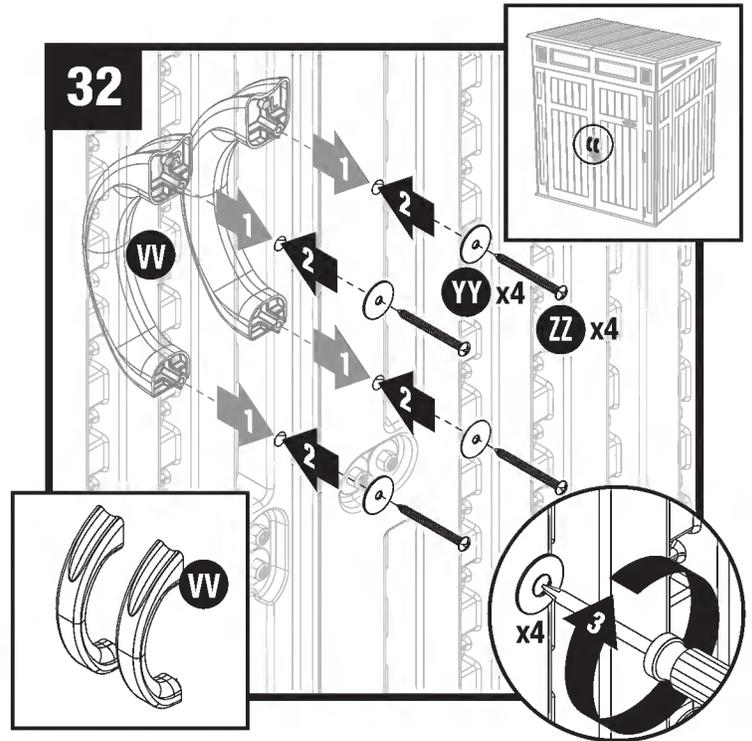
De l'extérieur de la porte, mettre les tiges filetées des poignées (VV) dans les trous des portes gauche et droite. Fixer les poignées en mettant une rondelle (YY) et un écrou (ZZ) sur chaque tige filetée et en serrant. Ne pas trop serrer. **NE PAS TROP SERRER.**
