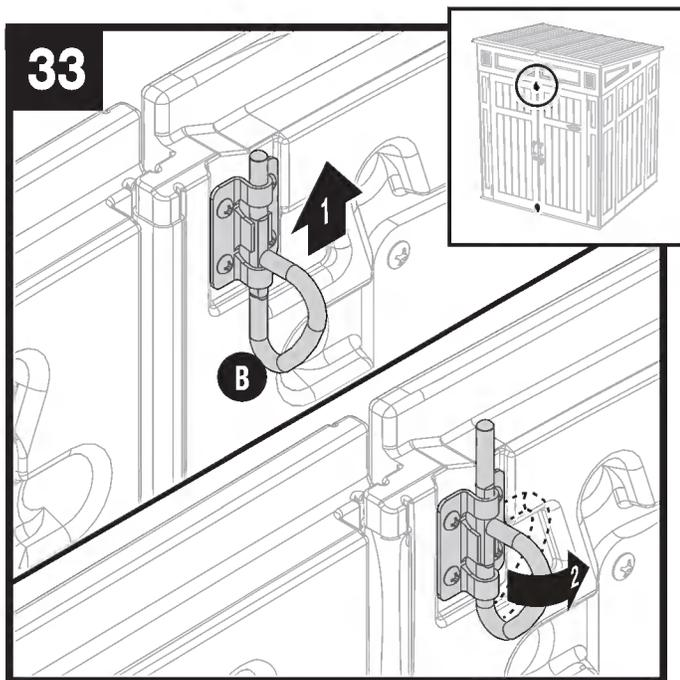
Soulever le verrou du haut (T) pour l'enfoncer dans son logement du chevêtre. Tourner le verrou à droite pour le verrouiller. Répéter l'opération avec un Anneau D inférieur (T).
