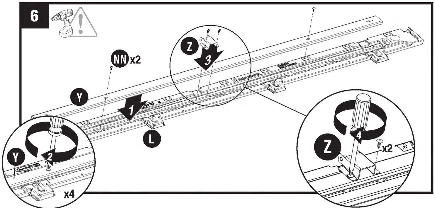
Placer le chevêtre arrière (L) sur une surface plane, face vers le bas. Placer le reste de la poutre du chevêtre (Y) dans la rainure à l'arrière du linteau. Fixez la poutre (Y) avec deux vis (NN). Placer la barre d'appui (Z) au centre de la poutre avec l'extrémité inférieure plate orientée vers le bas. Fixer la barre d'appui (Z) avec deux vis (NN).
