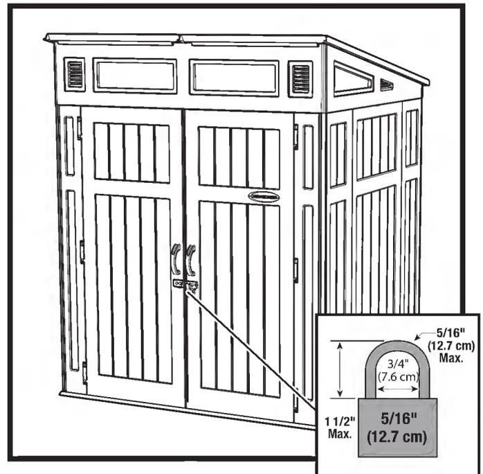
Pour verrouiller la remise de manière sûre, l'utilisation d'un cadenas de 5/16 po est recommandée.
