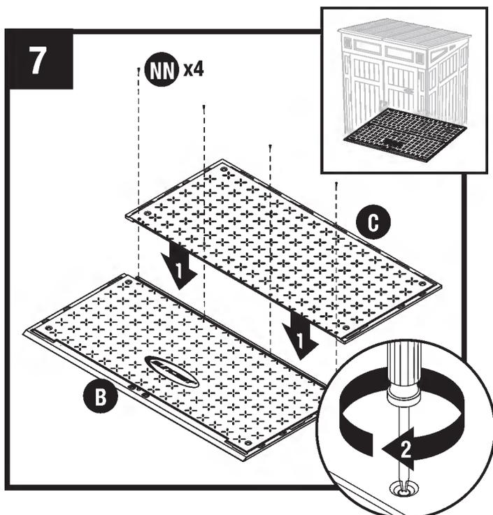
Mettre les panneaux de plancher avant (B) et arrière (C) bout à bout, et les fixer avec six vis (NN).
