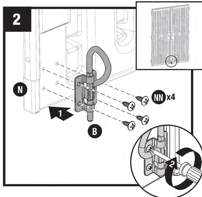
En bas de la porte gauche (N), du côté intérieur, fixer un verrou (T) par quatre vis (NN).
