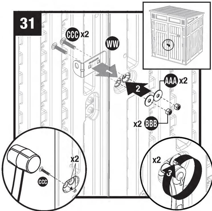
Faire passer deux vis (CCC) dans la plaque (WW) et la porte gauche. Tout en maintenant la plaque à l'extérieur de la porte, mettre une rondelle (AAA) et un écrou (BBB) sur chaque vis et serrer. Ne pas trop serrer. **NE PAS TROP SERRER.**
