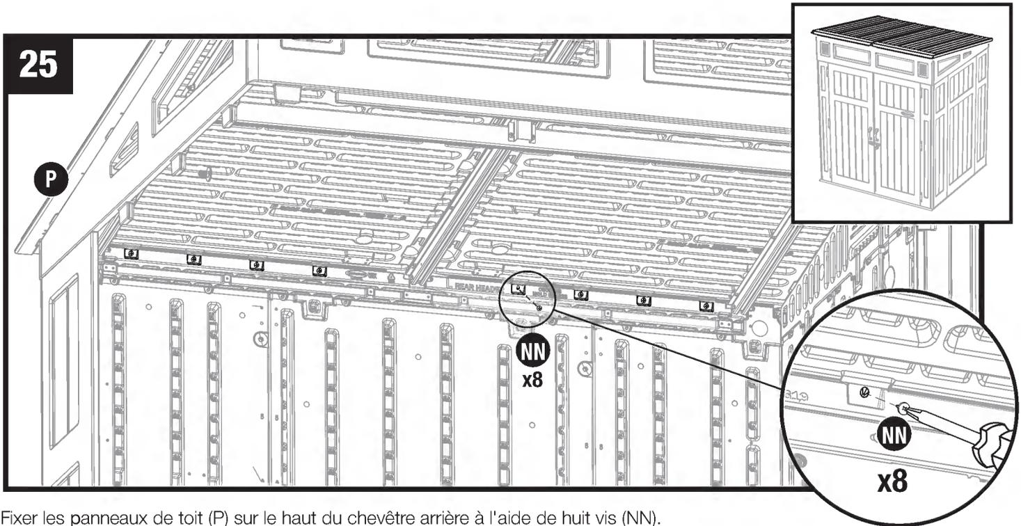
Fixer les panneaux de toit (P) sur le haut du chevêtre arrière à l'aide de huit vis (NN).
