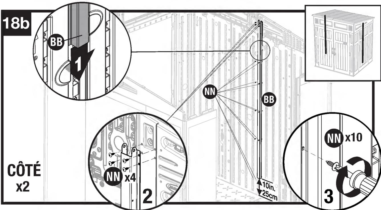
Fixez un adaptateur mural (BB) au mur latéral droit en le faisant glisser en place d'en haut. Sécuriser avec 14 vis (NN). Répétez les étapes avec l'adaptateur mural restant (BB) sur le côté gauche de l'intérieur du hangar
