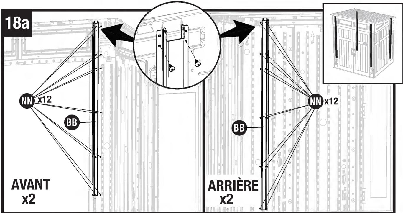
Placez un adaptateur latéral (BB) en position sur le côté droit de l'ouverture intérieure de la porte. Fixez avec 12 vis (NN). Placez un adaptateur latéral (BB) en position sur le coin arrière. Fixez avec 12 vis (NN).
