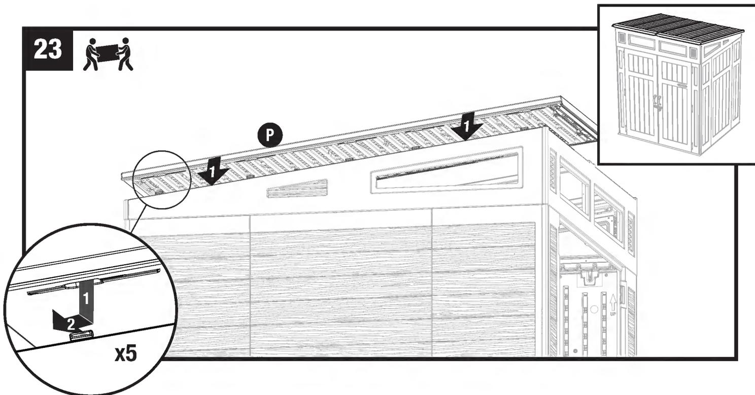
Aligner le panneau de toit restant (P) sur le chevêtre latéral gauche, les pattes du linteau s'emboîtant dans les fentes du panneau de toit. Faire glisser le panneau de toit vers le mur arrière jusqu'à ce que les cinq dispositifs de fixation soient complètement enclenchés.
