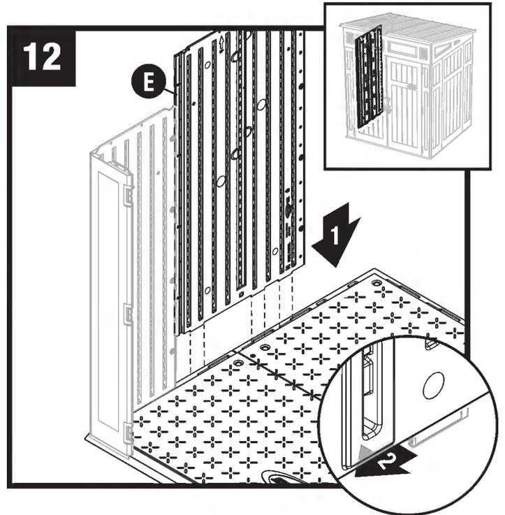
Aligner les pattes sous le panneau latéral (E) avec les fentes le long des planchers avant et arrière. Enfoncer le panneau dans les fentes et le verrouiller en place en le faisant glisser vers le coin avant.
