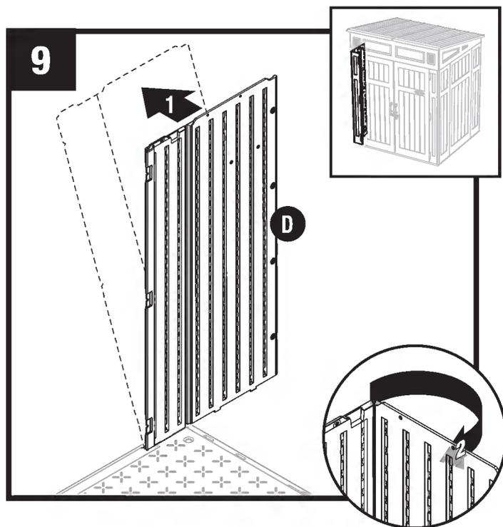
Incliner légèrement le coin avant gauche (D) vers l'extérieur et plier sa charnière.
