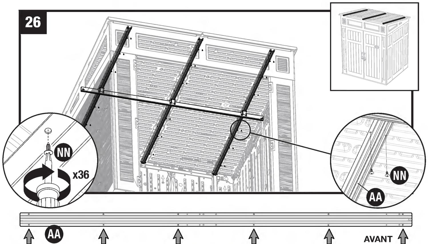
Chaque pied de ferme (AA) est fixé aux panneaux de toit (P) avec 12 vis (NN) aux emplacements des trous indiqués par des flèches.
