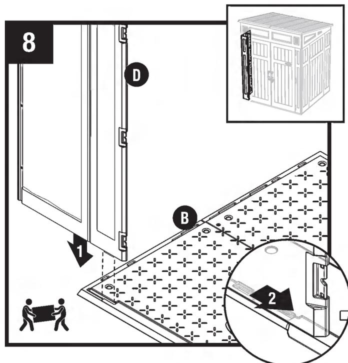
Alignez l'onglet en bas à droite du coin avant gauche (D) avec fente sur le plancher avant (B). Baisser le panneau dans la fente et verrouiller en place en glissant panneau vers l'ouverture de la porte.
