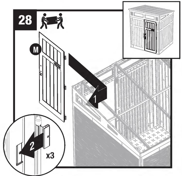
Avec les charnières en position ouverte, les mettre dans les emplacements prévus à cet effet du côté intérieur du panneau avant droit.
