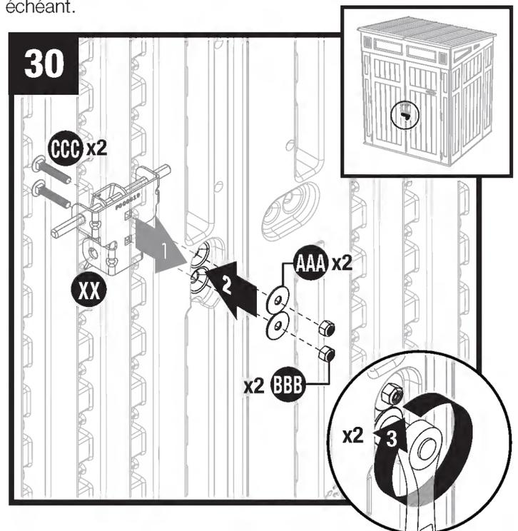
Mettre deux vis (CCC) dans la plaque (XX) et la porte droite. Tout en maintenant la plaque à l'extérieur de la porte, mettre une rondelle (AAA) et un écrou (BBB) sur chaque vis et serrer. Ne pas trop serrer.
