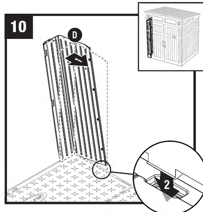
Remettre le coin avant gauche (D) en position verticale et aligner les pattes du côté droit avec les fentes du plancher.
