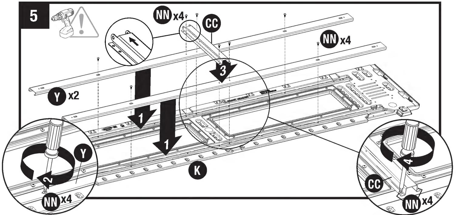
Placer le chevêtre avant (K) sur une surface plane, face vers le bas. Placer une poutre de chevêtre (Y) dans chaque rainure au-dessus et au-dessous des ouvertures de la fenêtre. Fixez les poutres (Y) avec deux vis (NN) chacune. Placer l'adaptateur du côté court (CC) entre les fenêtres avec l'extrémité inférieure plate orientée vers le bas. Fixer l'adaptateur (CC) avec quatre vis (NN).
