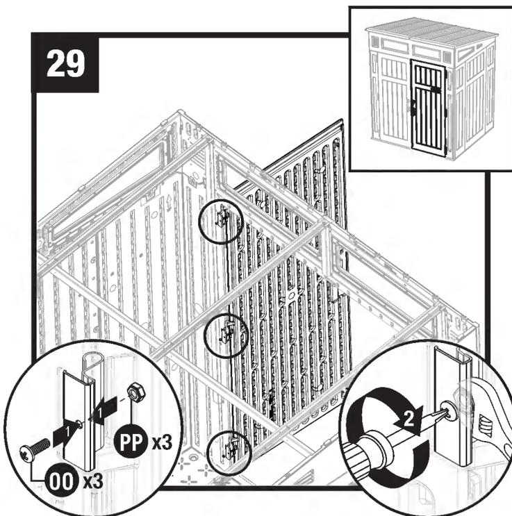
Fixer chaque charnière métallique par une vis (00) et un écrou (PP). Répéter les paragraphes 27-28 pour la porte gauche (N).
