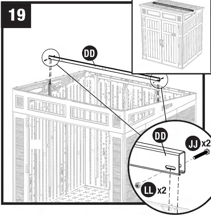
Placer la poutre faîtière (DD) dans la partie supérieure des deux adaptateurs latéraux montés sur le mur. Fixer avec un boulon (J) et un écrou (L) à chaque extrémité de la poutre faîtière.
