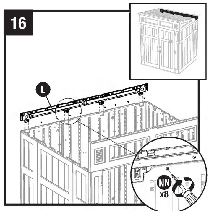
Placer le chevêtre arrière (L) sur le mur arrière et placer les quatre pattes qui dépassent dans les logements prévus dans le mur. Fixer le chevêtre arrière par huit vis (NN).
