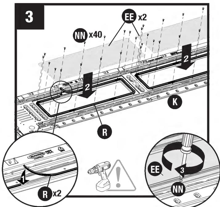
Placer le chevêtre avant (K) sur une surface plane, face vers le bas. Insérer un joint (R) dans la rainure autour de chaque ouverture de fenêtre. Poser une vitre (EE) sur chaque ouverture de fenêtre. Fixer les vitres avec 40 vis (NN).
