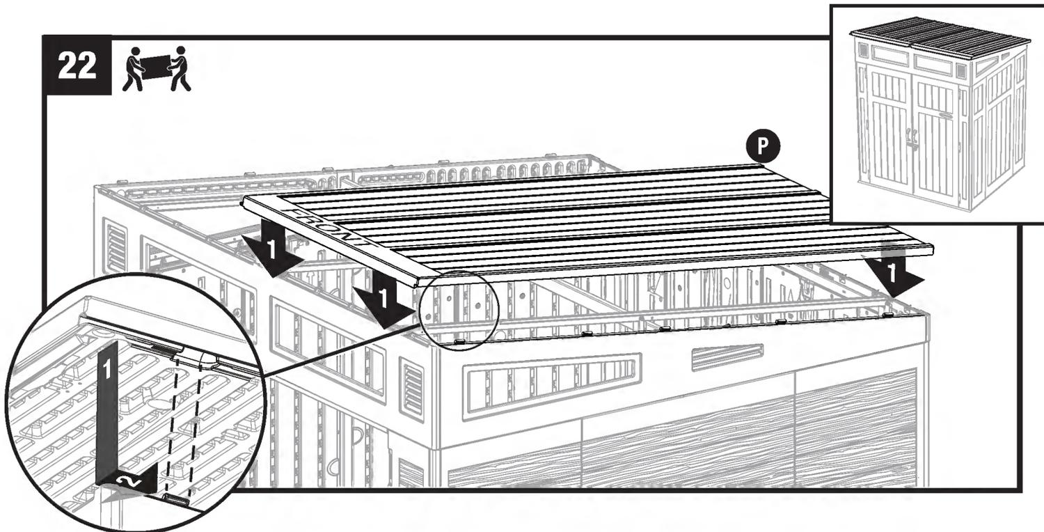
Aligner un panneau de toiture (P) avec le linteau de droite pour que les pattes du linteau s'alignent sur les cinq fentes du panneau de toit.
