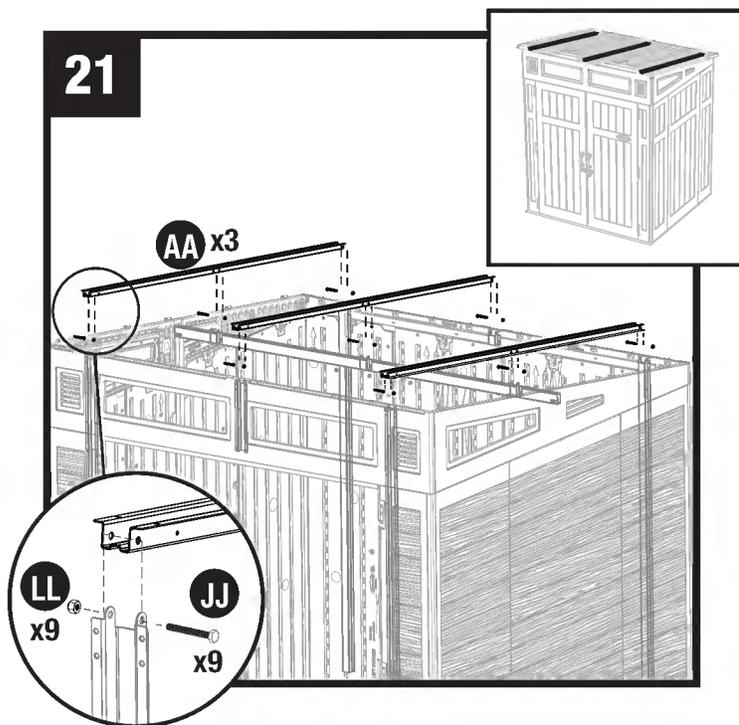
Placer un chevron de ferme (AA) sur les adaptateurs latéraux et la barre d'appui sur le mur arrière, la poutre faîtière et le chevêtre avant. Bloquer dans les trois barres d'appui à l'aide de boulons (J) et d'écrous (L).
