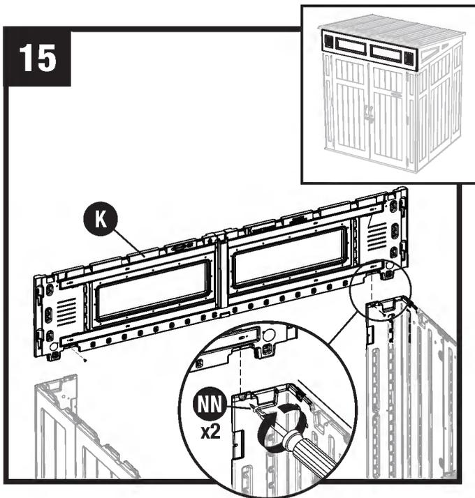
Placer le chevêtre avant (K) au-dessus de l'ouverture de la porte en enfonçant les deux pattes qui dépassent dans les logements situés dans les panneaux de coin avant. Fixer le chevêtre avant avec quatre vis (NN).
