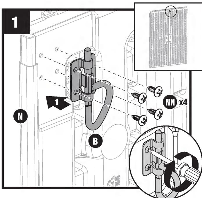
En haut de la porte gauche (N), du côté intérieur, fixer un verrou (T) par quatre vis (NN).
