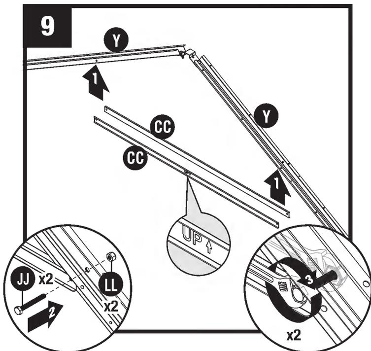
Acople dos vigas transversales de la armadura (CC) a los dos soportes de la armadura (Y) con dos pernos hexagonales (JJ) y dos tuercas de cierre (LL).
