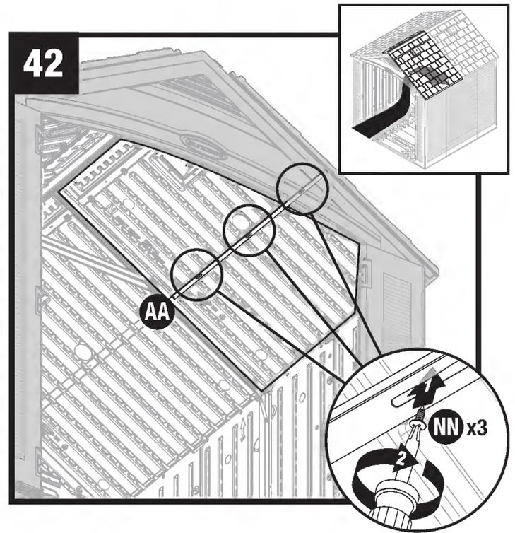
Asegure el soporte del techo (AA) al techo con tres tornillos (NN). Eleve el segundo soporte del techo (AA) a la parte de arriba del panel del techo. (Mostrado en el paso siguiente)
