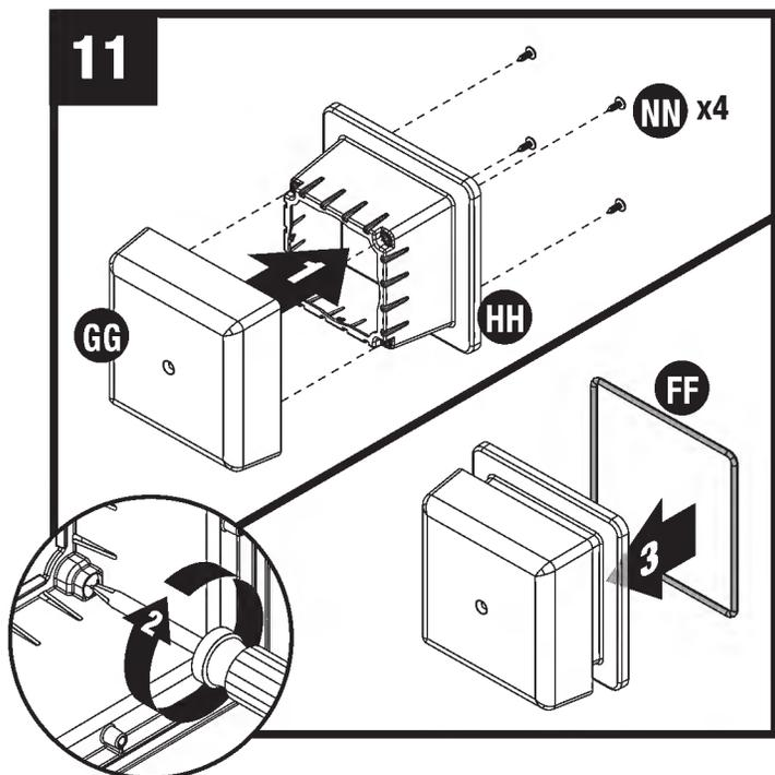
Coloque la cubierta Illumivent™ (GG) sobre la base (HH). Asegure desde abajo con cuatro tornillos (NN). Coloque la empaquetadura (FF) dentro de la base de Illumivent™ (HH).
