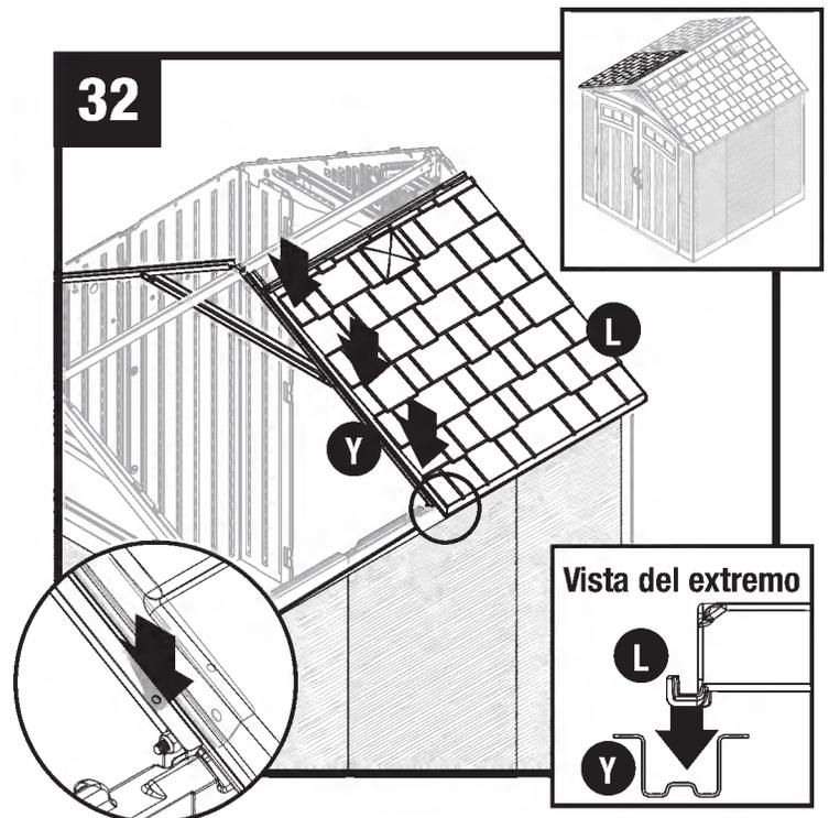
Presione el borde del techo derecho (L) dentro del canal del soporte de la armadura (Y).
