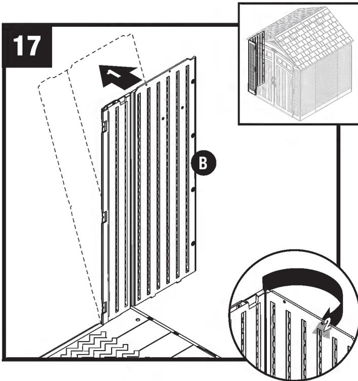
Incline un poco la esquina frontal izquierda (B) hacia adelante y doble la bisagra de la esquina.
