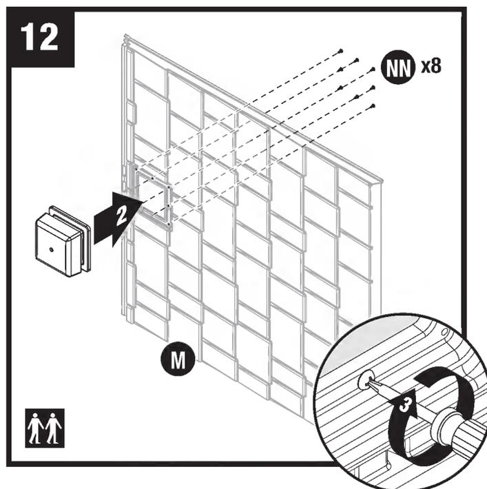
Coloque el ensamble Illumivent™ (GG, HH, FF) sobre el panel del techo derecho (M). Asegure desde abajo con ocho tornillos (NN). Entornille las esquinas primero. Asegúrese de que el acanalado de las partes de plástico esté completamente asentado contra la empaquetadura en la cubierta Illumivent™. Repita el procedimiento con las partes restantes del panel de techo derecho.
