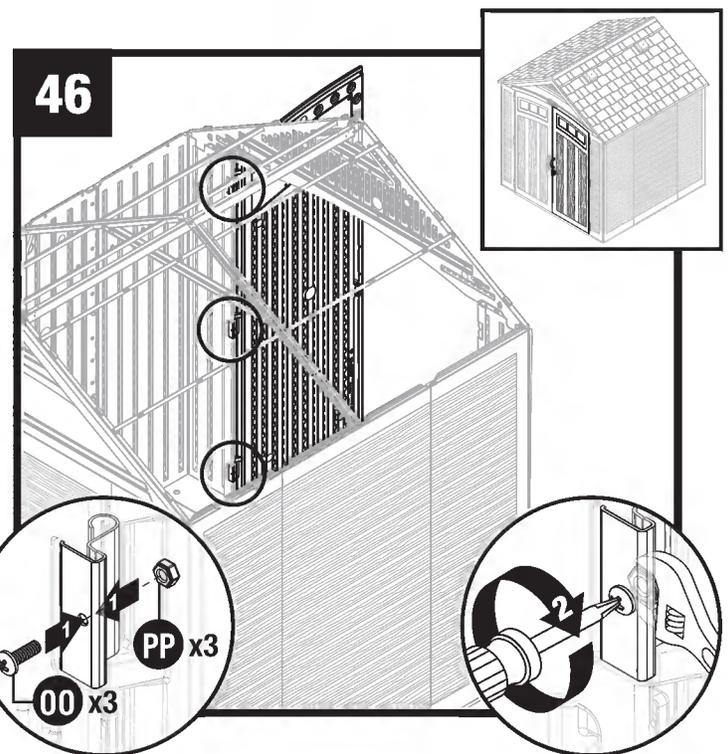
Con la placa de la bisagra abierta, deslice una bisagra sobre cada receptáculo en el interior del panel frontal derecho.
