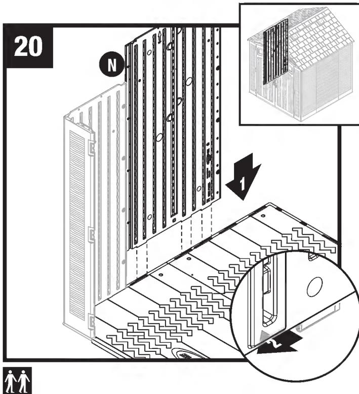
Alinee las lengüetas de la parte inferior del panel lateral (N) con las ranuras frontal y trasera. Descienda el panel dentro de las ranuras y asegúrelo en su lugar deslizándolo hacia la esquina frontal.
