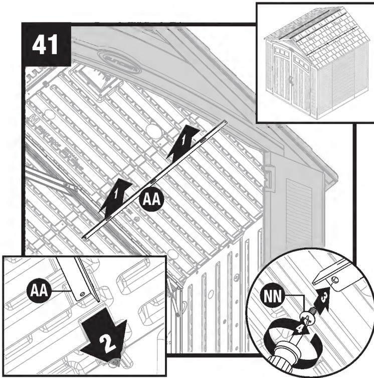
Eleve el soporte del techo (AA) en su posición contra el techo. Deslice el soporte del techo (AA) dentro del aguilón frontal. Asegure el soporte del techo a la parte inferior del soporte de la armadura con un tornillo (NN).
