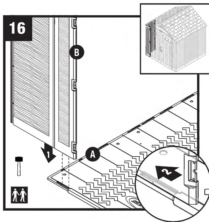
Alinee la lengüeta de la parte inferior de la esquina frontal izquierda (B) con la ranura del piso izquierdo (A). Descienda el panel dentro de la ranura del panel y asegúrelo en su lugar deslizando hacia fuera del piso.
