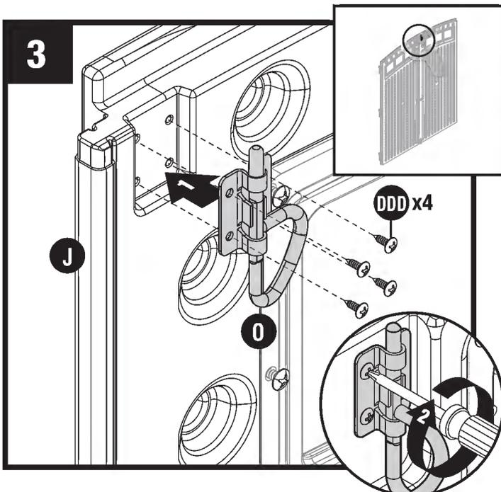
En el lado interior superior de la puerta izquierda (J), coloque un pestillo con anillo D (O) con cuatro tornillos (DDD) a través de los agujeros existentes.
