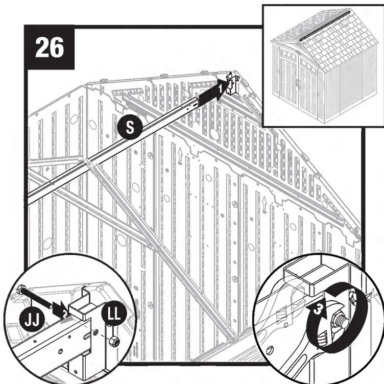
Eleve la viga del caballete (S) e introdúzcala dentro del soporte de la viga del caballete trasera del techo. Asegure con un perno hexagonal de 2 pulg. (JJ) y una tuerca de cierre (LL). Repita el procedimiento con el soporte de la viga del caballete frontal.
