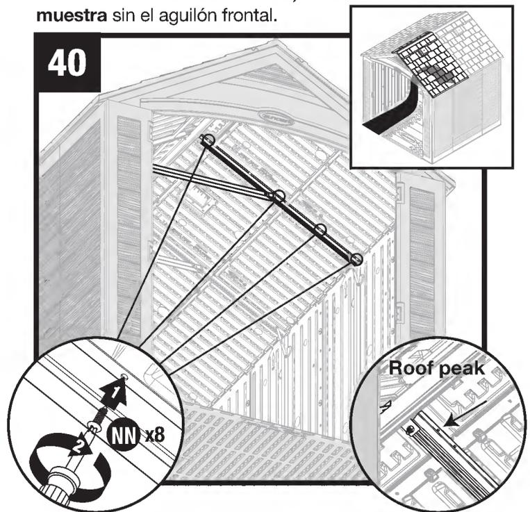
Asegure el techo a ambos lados de la armadura del techo con ocho tornillos (NN). Cada tornillo se entornillará en su agujero correspondiente en el techo. Asegúrese de que la cima del techo esté segura (los agujeros de tornillo más altos en la armadura del techo).
