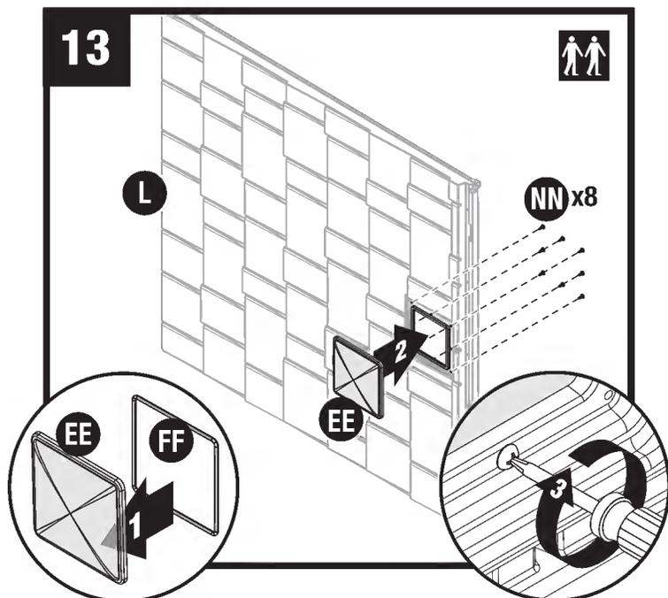
Coloque la empaquetadura del tragaluz (FF) dentro del tragaluz (EE). Coloque el tragaluz (EE) sobre el panel de techo izquierdo (L). Asegure desde abajo con ocho tornillos (NN). Entornille las esquinas primero. Asegúrese de que el acanalado de las partes de plástico esté completamente asentado contra la empaquetadura del tragaluz. Repita el procedimiento el panel de techo izquierdo.
