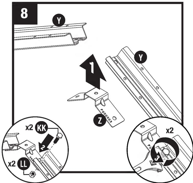
Acople la base de la armadura (Z) al extremo de uno de los soportes de la armadura (Y) con un perno hexagonal de 1 pulgada (KK) y una tuerca de cierre (LL).
