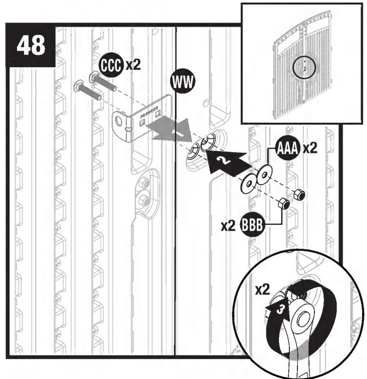
Inserte tornillos (CCC) dentro de la placa del pestillo izquierdo (WW) y a través de la puerta **izquierdo**. Sujetando la placa en su lugar en el exterior de la puerta, asegure cada tornillo con dos arandelas (AAA) y dos tuercas de cierre (BBB).
