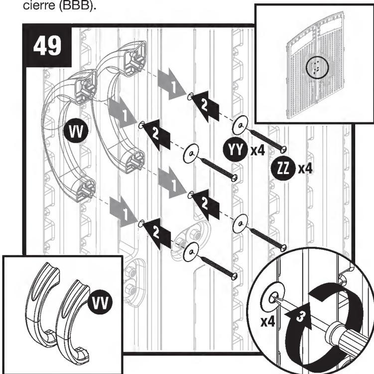
Desde la parte exterior de las puertas, inserte los vástagos de la manija de la puerta (W) dentro de los agujeros de las puertas izquierda y derecha. En el interior de las puertas, coloque arandelas (YY) en cada vástago de la manija de la puerta, y asegure cada uno con un tornillo (ZZ).
