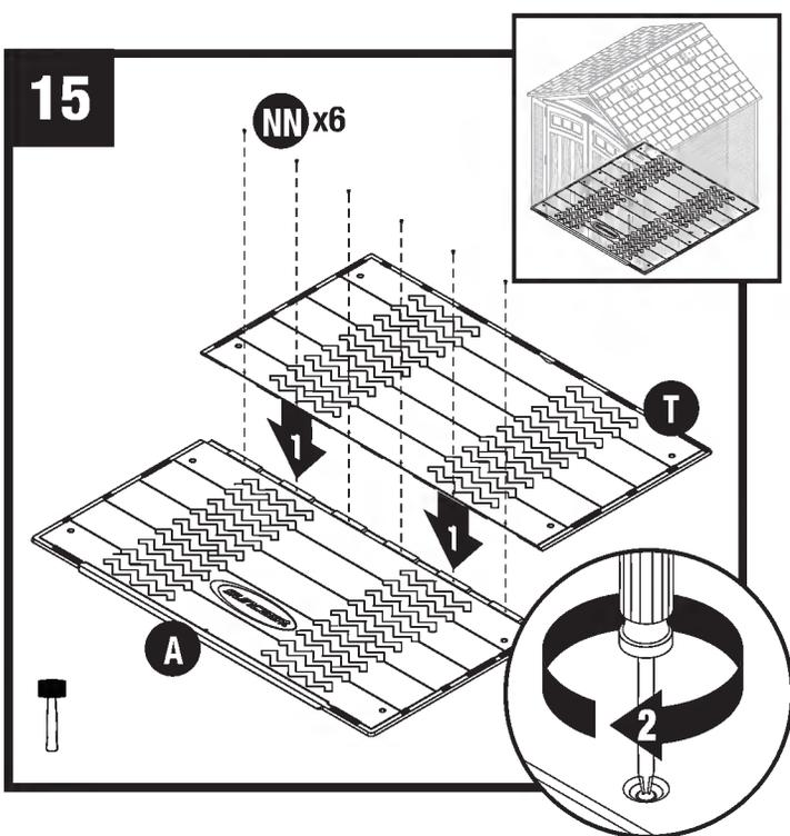
Una a presión los paneles del piso izquierdo (A) y derecho (T) y asegúrelos con seis tornillos (NN).
