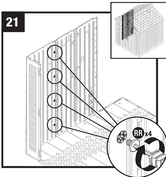
Asegure el panel lateral con cuatro pernos Easy Bolt (RR), empezando desde el piso y avanzando hacia el techo. NO use llave dinamométrica. Use el atornillador Easy Bolt (SS) y apriete a mano. La cabeza del perno Easy Bolt estará al ras cuando esté completamente instalado. NO apriete más de lo necesario los pernos Easy Bolt.
