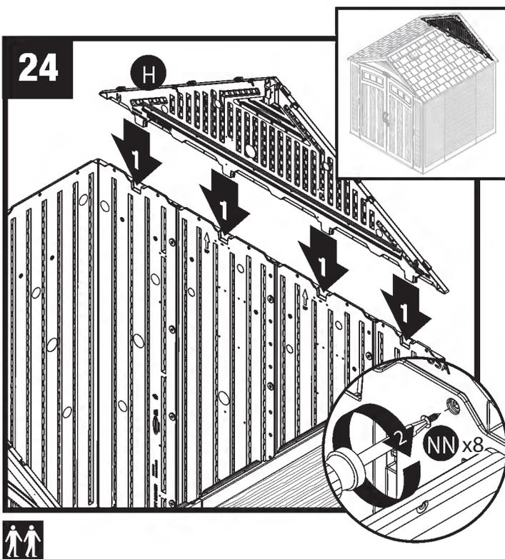
Coloque el aguilon trasero (H) sobre las paredes traseras y encaje los cuatro soportes protuberantes dentro de los bolsillos moldeados en las paredes traseras. Asegure el aguilon trasero con ocho tornillos (NN).
