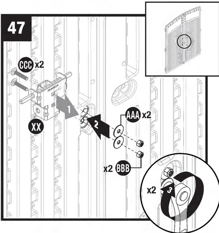
Inserte dos tornillos (CCC) dentro de la placa del pestillo el derecho (XX) y a través de la puerta **derecho**. Sujetando la placa en su lugar en el exterior de la puerta, asegure cada tornillo con dos arandelas (AAA) y dos tuercas de cierre (BBB).
