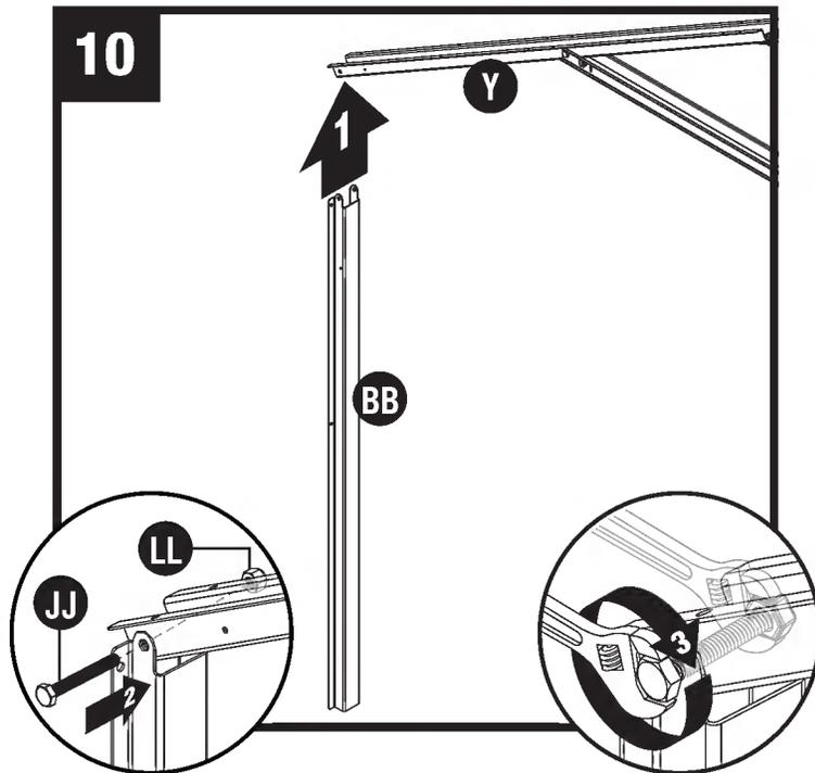
Coloque el soporte del adaptador lateral (BB) al final del soporte de la armadura izquierda (Y). Asegure el soporte del adaptador con un perno hexagonal de 2 pulg. (JJ) y una tuerca de cierre (LL). Repita el procedimiento con el otro soporte de armadura.
