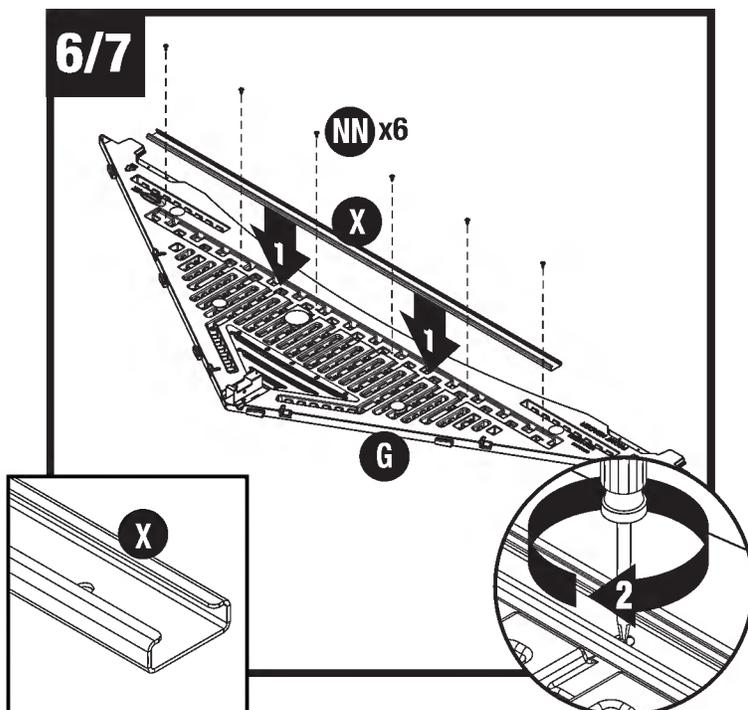
Coloque el aguilon frontal (G) sobre el piso con las letras hacia arriba. Coloque la viga del aguilon frontal (X, 57 pulg.) dentro del bolsillo en el interior del aguilon frontal (G). Instale con seis tornillos (NN)
