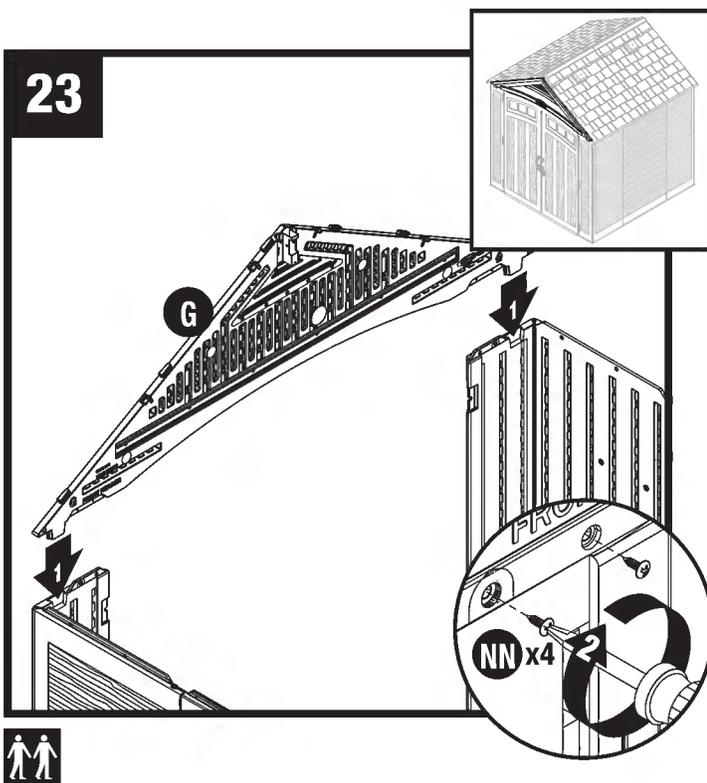
Coloque el aguilon frontal (G) sobre la abertura de la puerta y encaje los cuatro soportes protuberantes dentro de los bolsillos moldeados en las esquinas frontales. Asegure el aguilon frontal con dos tornillos (NN) en cada esquina frontal.
