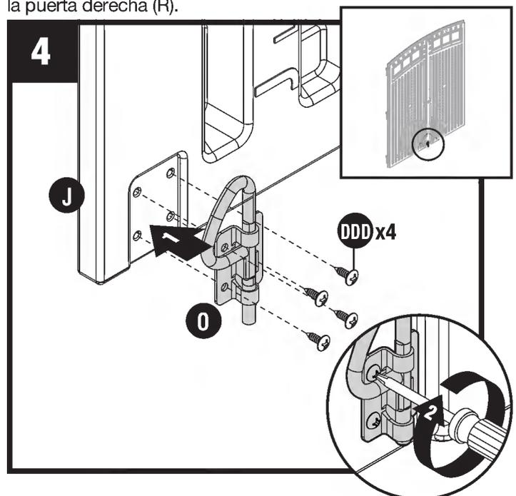
En el lado interior inferior de la puerta izquierda (J), coloque un pestillo con anillo D (O) con cuatro tornillos (DDD) a través de los agujeros existentes.
