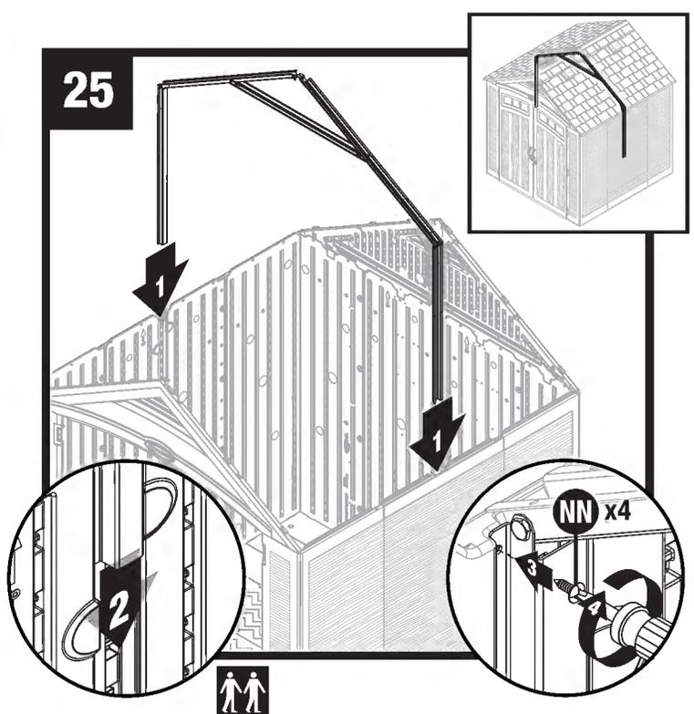
Deslice el ensamble de la armadura y colóquelo en su lugar. Asegure con cuatro tornillos (NN) en cada soporte adaptador lateral.
