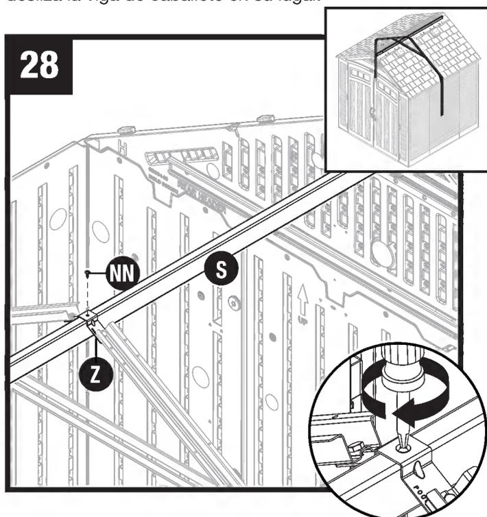
Acople la base de la armadura (Z) a la viga de caballete (S) con un tornillo NN.
