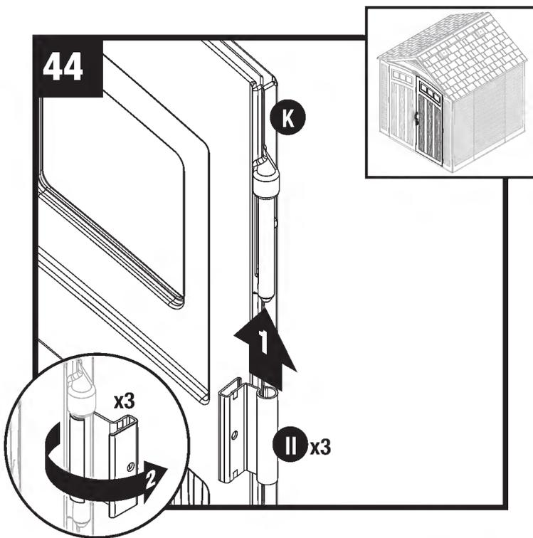
Coloque la puerta derecha (K) en posición vertical con las tres monturas de bisagra orientadas hacia la derecha. Deslice e instale una placa de bisagra metálica (II) sobre cada soporte de bisagra. Rote las bisagras hacia fuera de la puerta.
