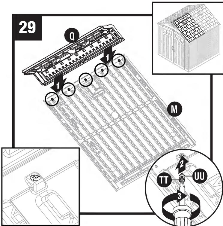
Coloque la cima del techo frontal (Q) sobre el panel de techo derecho (M).
