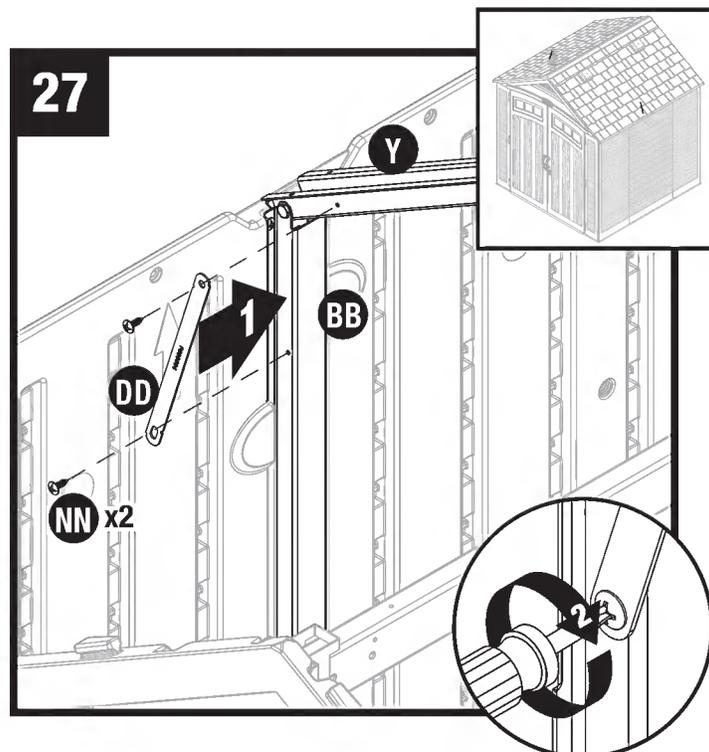
Acople el sujetador de la armadura (DD) al soporte adaptador lateral (BB) y el soporte de la armadura (Y) con dos tornillos (NN).
